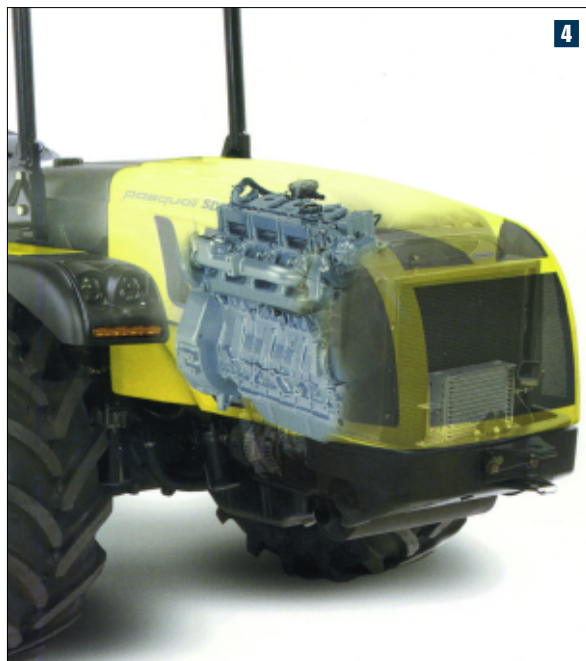
Foto 4. La posición muy adelantada del motor, prácticamente encima del eje delantero, representa una enorme ventaja para la adherencia del tractor y para la capacidad de elevación del hidráulico.
