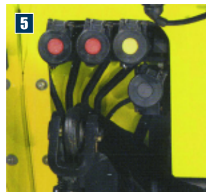
Foto 5. Las opciones de salidas para servicios exteriores son muy completas y pueden, opcionalmente, disponer de un mando único tipo joystick.
