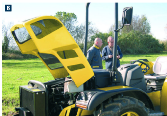
Foto 6. El tractor, con el capó abierto. Nótese la facilidad de acceso a todos los puntos de mantenimiento, en particular los dos radiadores frontales.
