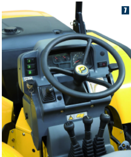
Foto 7. La dirección es suave y precisa y la posición de los pedales, correcta. El accionamiento de las palancas de cambio, igualmente suave y de recorridos cortos. La impresión de la situación del resto de controles es de fácil de acceso y de fácil memorización.
